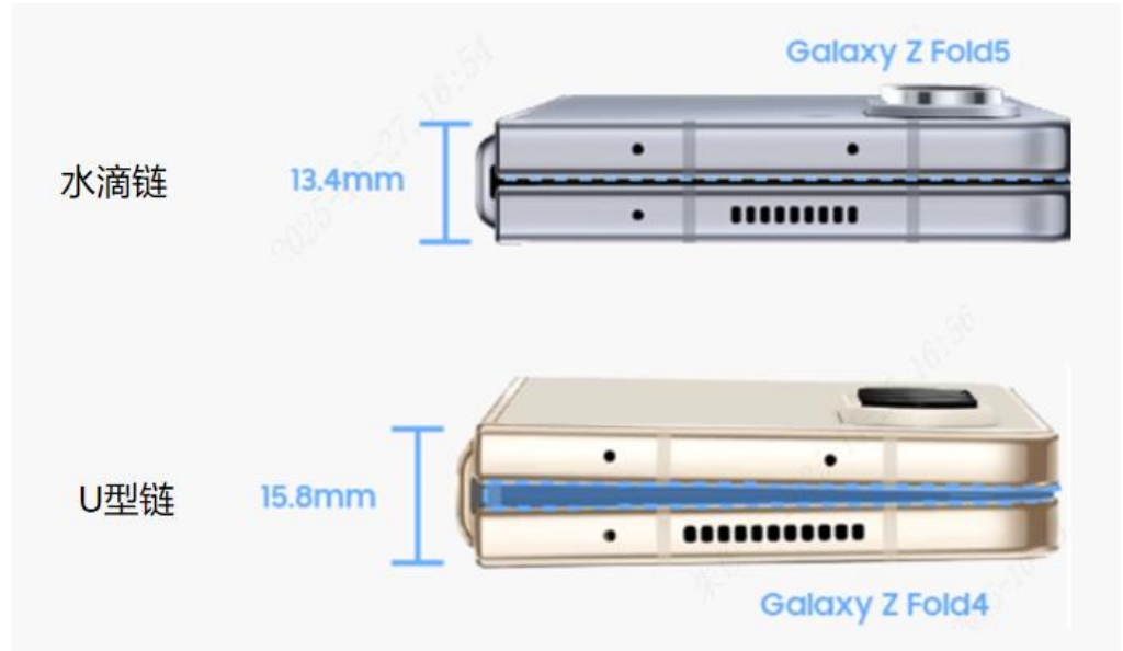
图表 24：Galaxy Z Fold 5 相较于 Galaxy Z Fold 4 机身厚度降低了约 2.4 毫米
