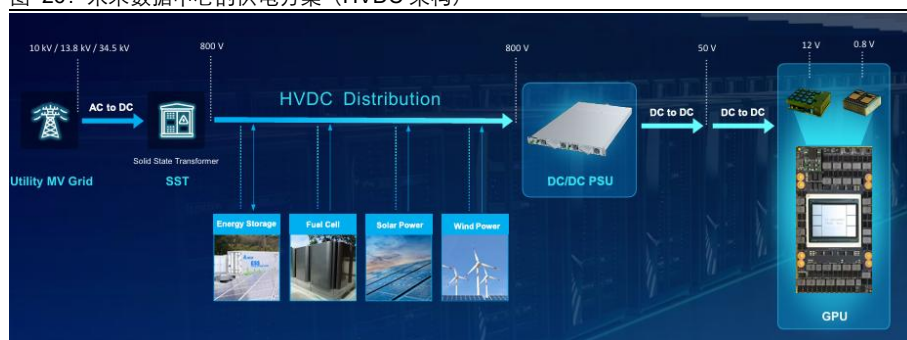
图 26: 未来数据中心的供电方案（HVDC 架构）
