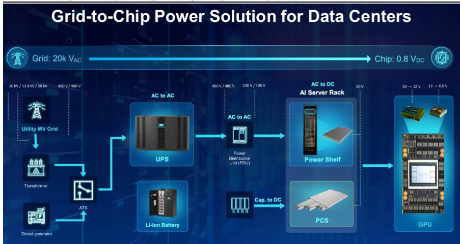
图 22：数据中心从电网到芯片的供电解决方案（UPS 架构）
