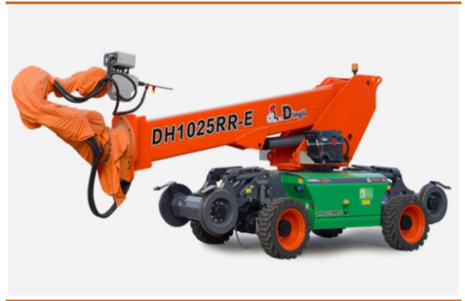
图 33 浙江鼎力隧道打孔机器人
