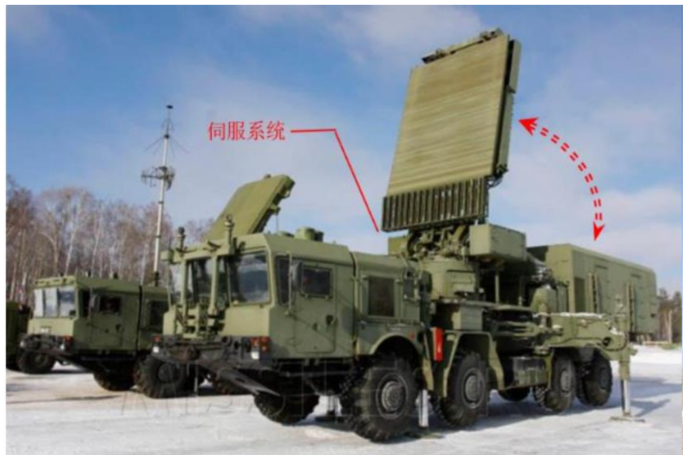
图19：伺服系统可用于雷达天线姿态调整
