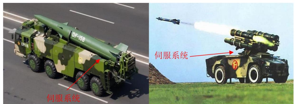
图18：导弹发射装置上，伺服系统可用于起竖机构、调平机构等执行机构
