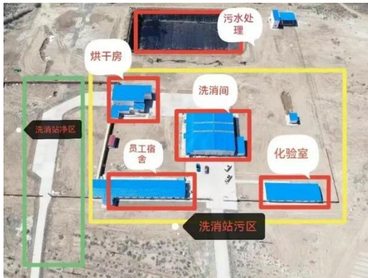
图 25: 智能洗消中心科学的物理布局和流程设计
