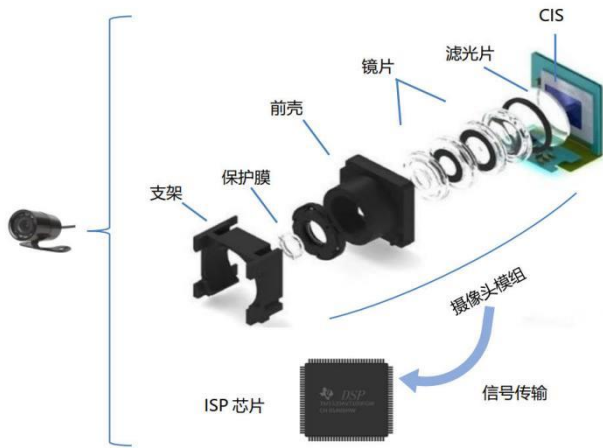
图 25 车载摄像头零部件示意图
