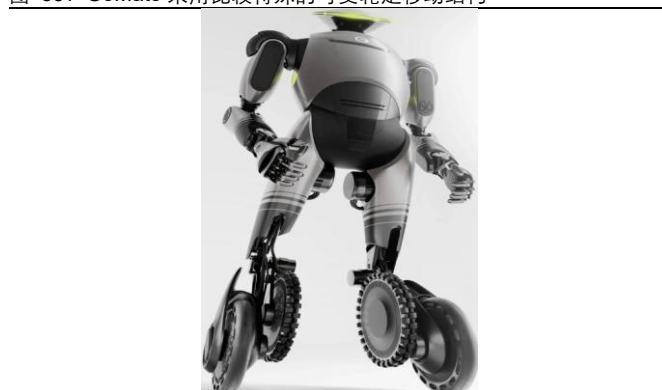
图 55: GoMate 采用比较特殊的可变轮足移动结构
