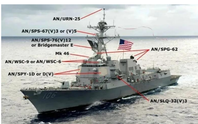
图表19: “阿利·伯克”级驱逐舰安装多个反导、防空雷达
