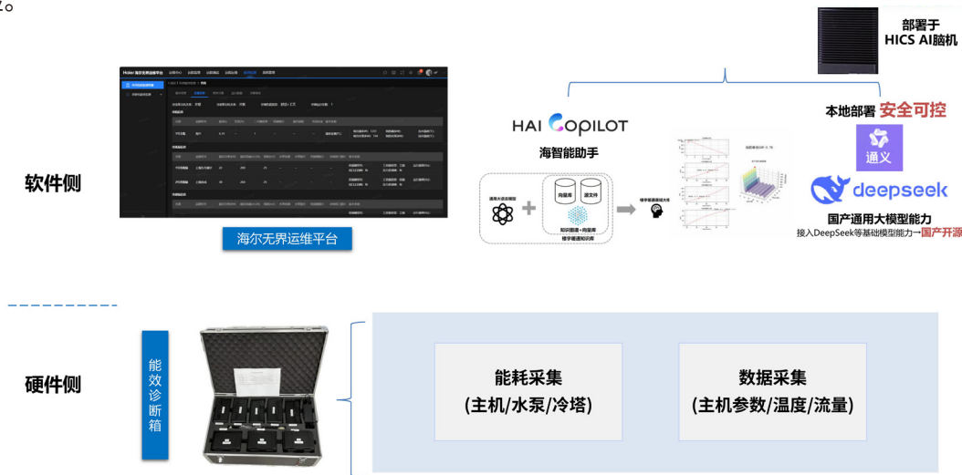
图5-1 海尔智慧楼宇能效诊断箱
