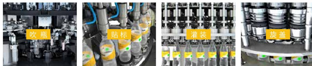
图表2：公司吹贴灌旋一体机实现了占地面积、操作人员节省经济性较强
