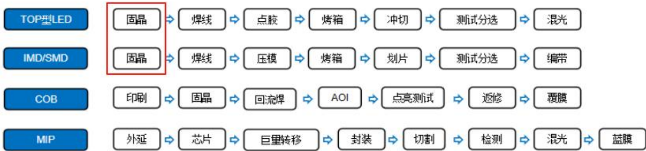
图表 23: LED 主要封装工艺流程
