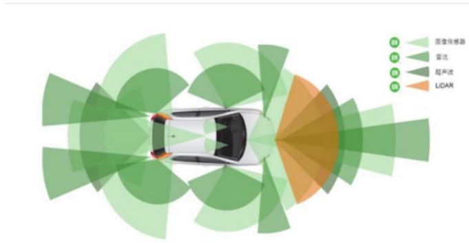
图表33: ADAS 整车传感器分布图
