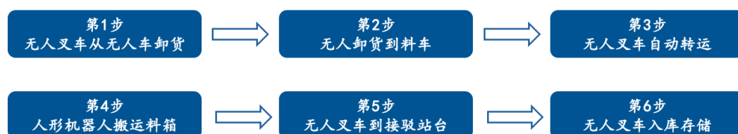
图表32：仓内物流自动化从原材料接收至存储的整套无人解决方案
