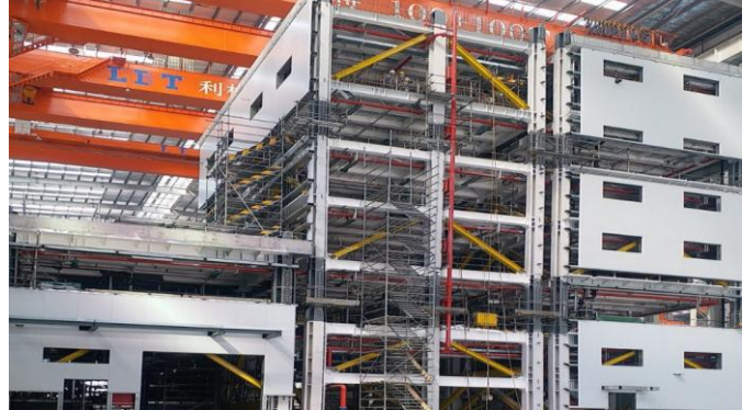
图表23: 巴斯夫抗氧化剂项目预制车间内模块
