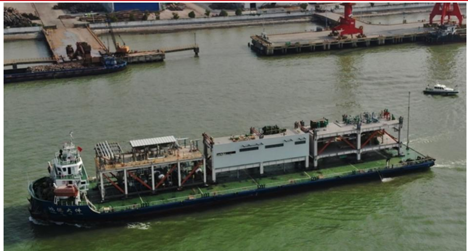
图表24: 英威达聚合物三期扩建项目大型工业模块在离港运输中
