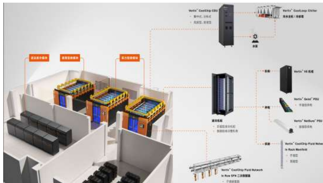
数据中心“风液共存”制冷模块布局及冷板液冷系统示例（维谛技术）
