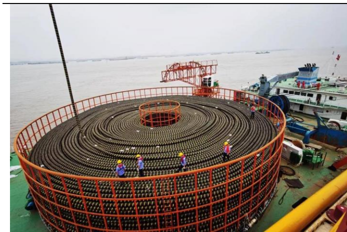
图40： 海缆敷设船在港口接缆
