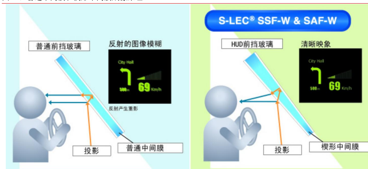
图 35：普通中间膜和楔形中间膜成像原理
