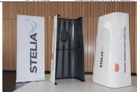
图 38: Stelia 公司研制的 CF/PEEK 热塑性复合材料机身验证件
