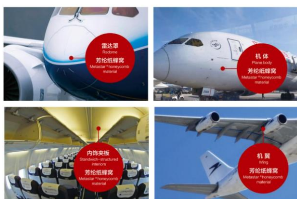
图 18：公司芳纶纸蜂窝在飞行器上的应用
