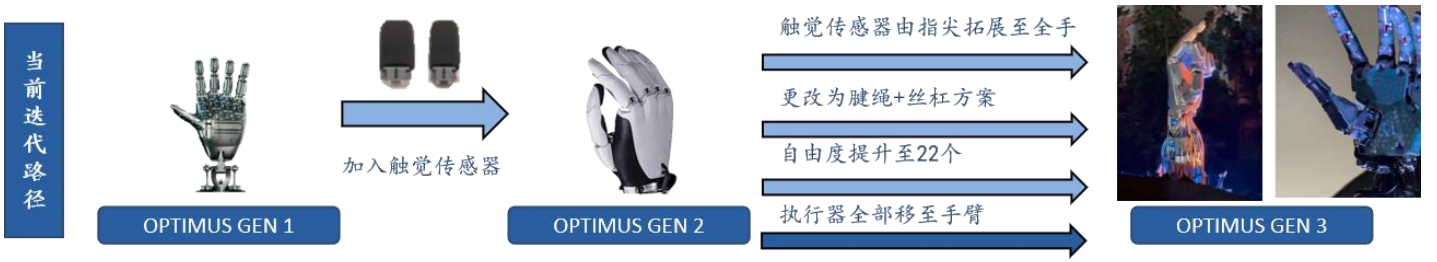
图表18: 特斯拉 Optimus 灵巧手迭代情况
