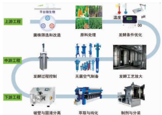
图表90：现代发酵放大工艺的流程示意图
