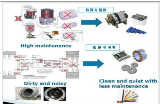
图12 EMB 与传统气制动系统结构和维保比较
