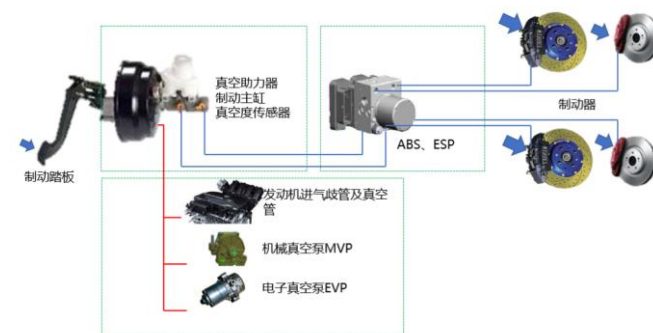
图2 电子真空泵工作原理示意图
