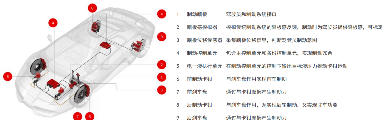
图11 Brembo 智能制动系统 SENSIFY 采用 EHB（前轮）+EMB（后轮）
