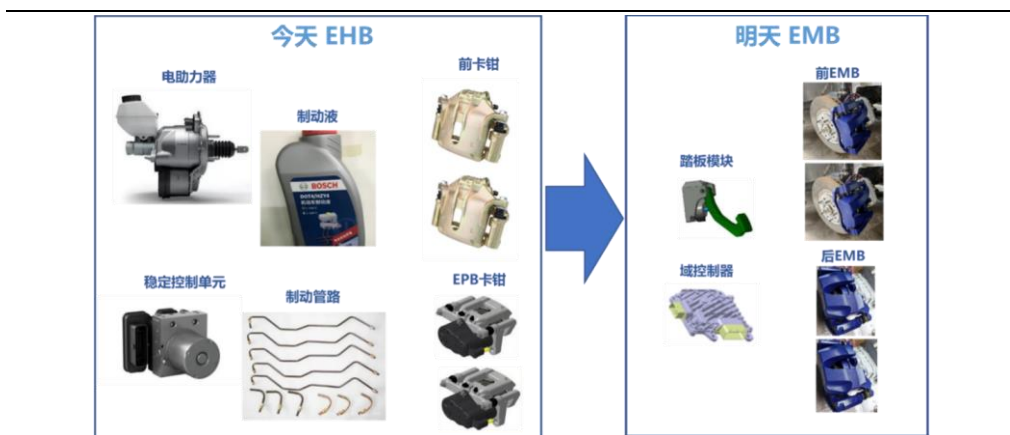
图5 EMB 与 EHB 结构对比
