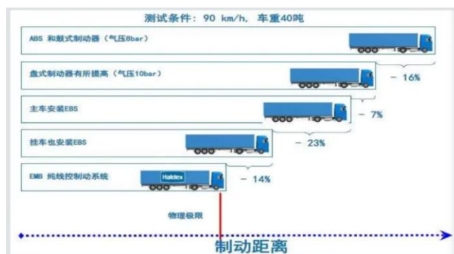
图13 EMB 与传统气制动系统制动距离比较
