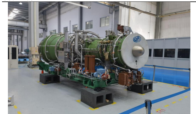
图 43：25MW 双燃料燃气轮机发电机组在 10 万吨级深水半潜式浮动平台上应用
