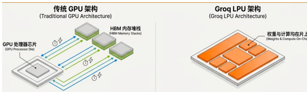
图 30：Groq 的 LPU：一种创新的片上 AI 内存架构
