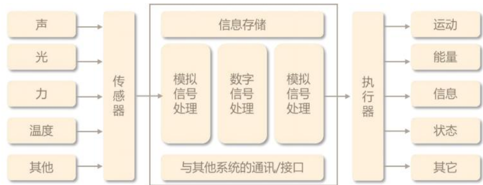
图表 11：MEMS 工作原理
