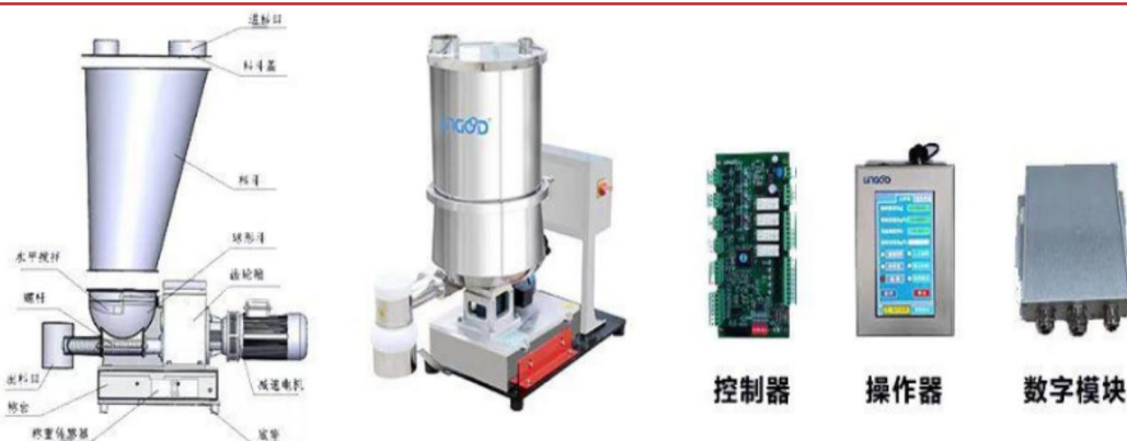
图表 38：失重式动态计量原理示意图
