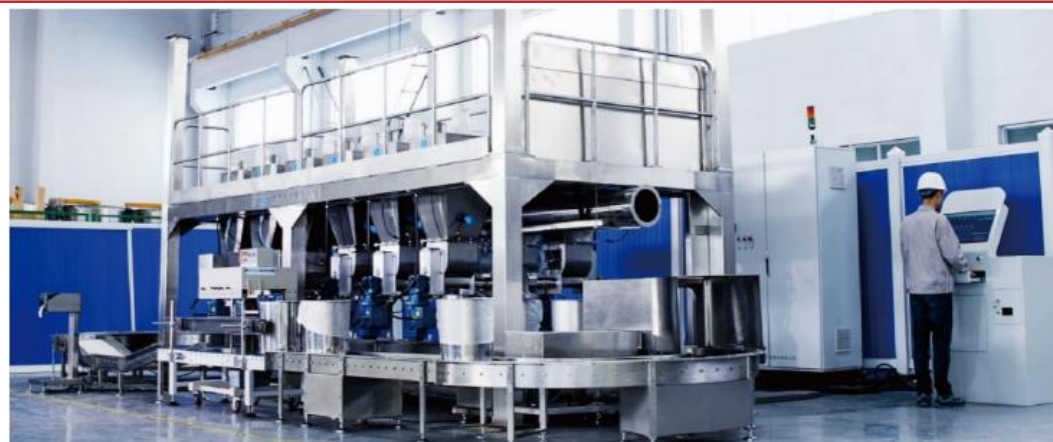
图表 29：智能微量配料系统实物图
