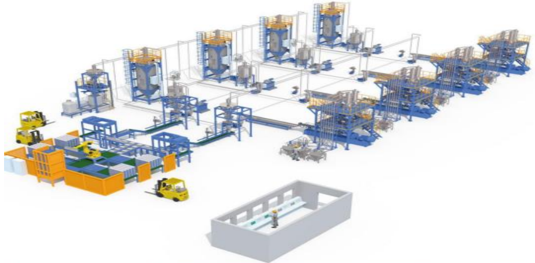
图表 28：自动计量配混输送系统示意图及实物图
