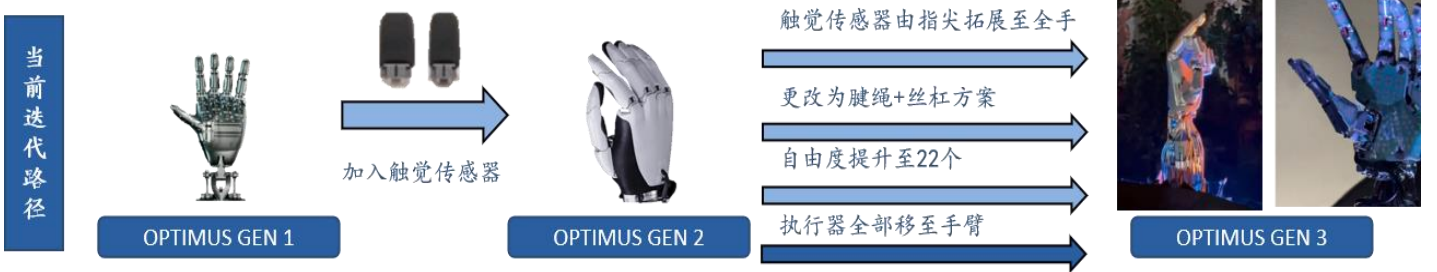
图表32：特斯拉 Optimus 灵巧手迭代情况
