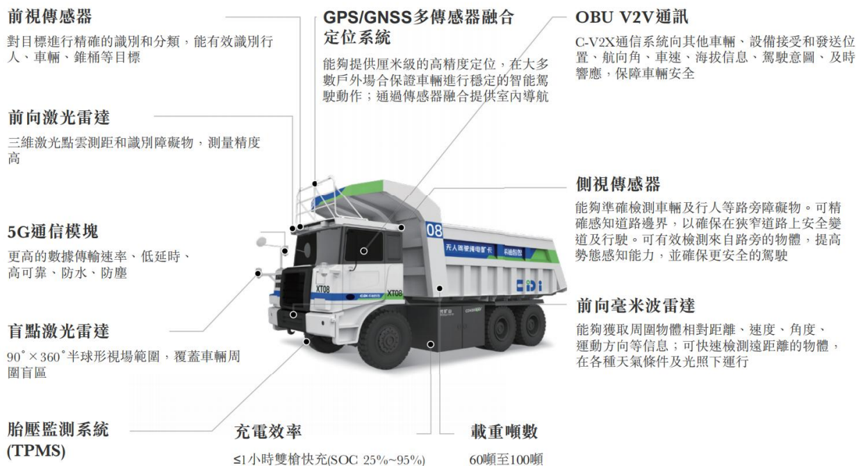
图35: 希迪智驾自动驾驶矿卡车规级传感器配置
