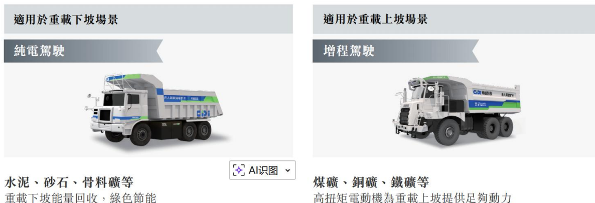
图36: 希迪智驾与汽车 OEM 联合开发不同类型的自动驾驶采矿车辆
