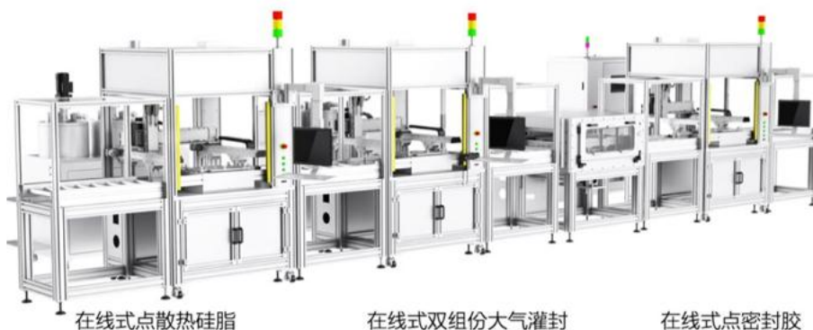
图 12：公司新能源真空灌胶生产线可用于电池管理系统生产
