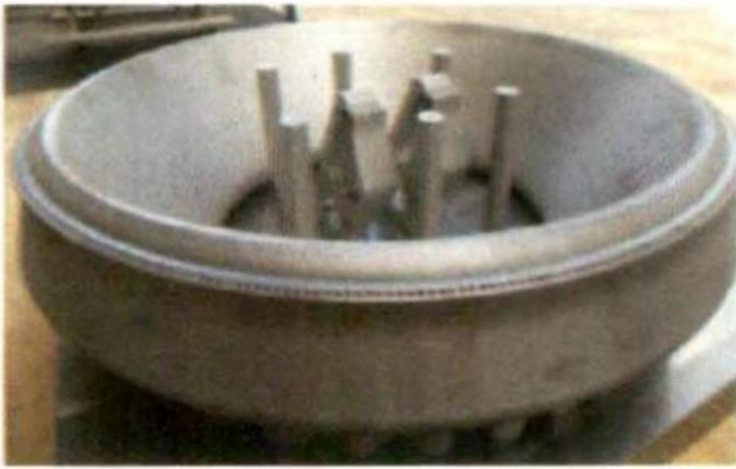
图表39: NASA 通过 SLM 打印的再生冷却喷管
