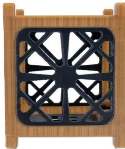
图表78: 通过 PEEK 材料打印的立方体卫星
