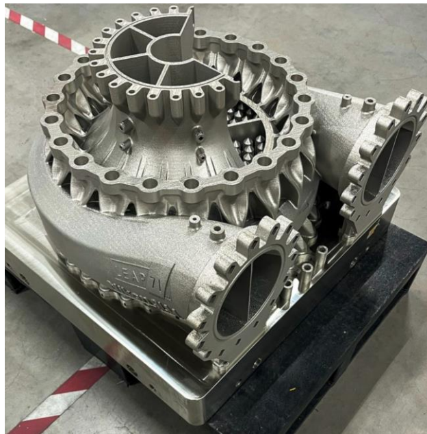
图表38: LEAP 71 宣布实现了直径 600 毫米喷注器 3D 打印
