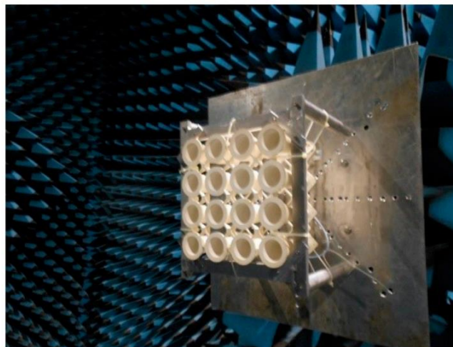
图表77: 直接金属激光烧结制成的天线馈源阵列
