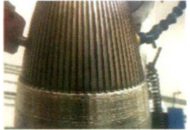
图表40: NASA 通过 LWDC 技术打印的再生冷却喷管
