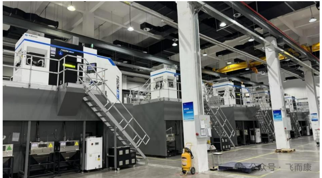
图表93：飞而康列装 3D 打印设备 50+台，配套 YF-75DA 发动机部分 3D 打印任务
