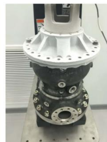
图表48: NASA 3D 打印的涡轮泵零件数量大幅减少
