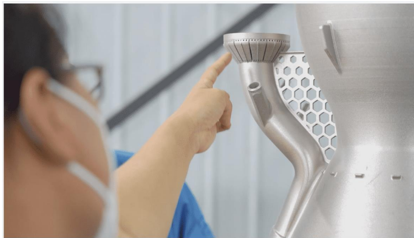
图表88：深蓝航天使用华曙高科设备进行发动机大尺寸喷管 3D 打印
