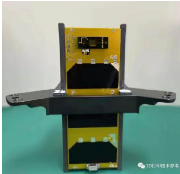
图表81: 星众空间金属 3D 打印的“灵巧号”卫星
