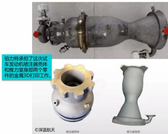
图表25: 深蓝航天通过结构与散热功能集成进一步提高发动机推力室效率
