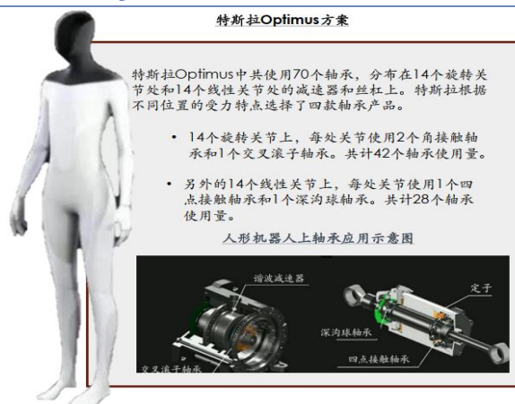
图32：特斯拉 Optimus 方案单个人形机器人的轴承使用
