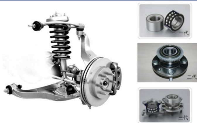
图17: 汽车轮毂轴承演变
