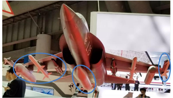
图表30: 2019 年迪拜航展 L15B 模型, 腹中线、翼下、翼尖均能挂载武器
