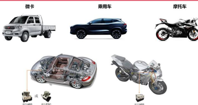
图表36：公司液压 ABS/ESC 应用领域以及在乘用车和摩托车的安装位置
