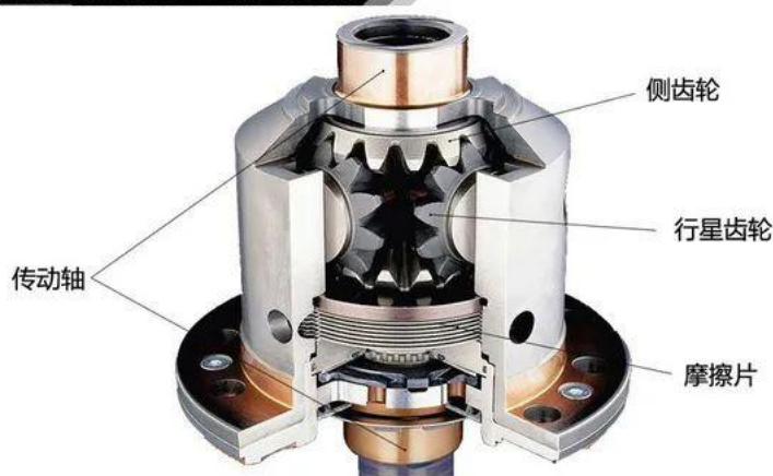
带摩擦片的限滑差速器结构图
