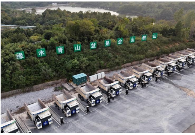
图27: 公司于台泥向容矿部署的 14 台纯电无人矿卡
