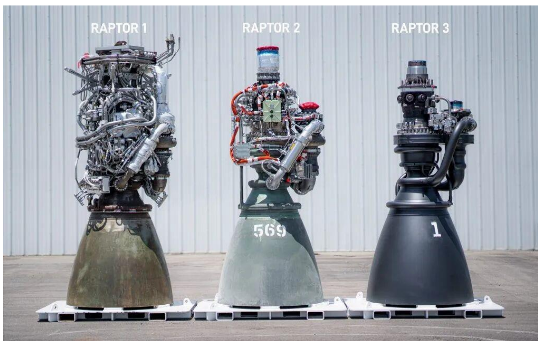
图表41：三代猛禽发动机从外观设计、零部件整合、发动机推力上均得到大幅优化提升
