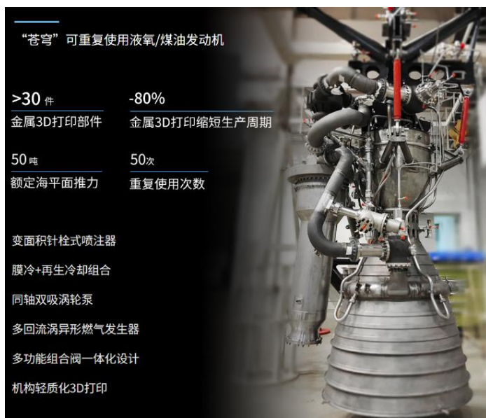
图表44：“苍穹”可重复使用液氧/煤油发动机 30 余款 部件采用公司 3D 打印解决方案
