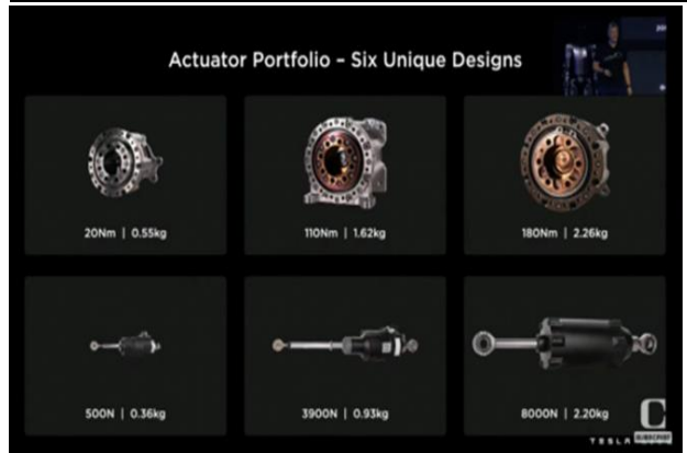
图22：特斯拉机器人关节设计沿袭工业机器人和自动化
