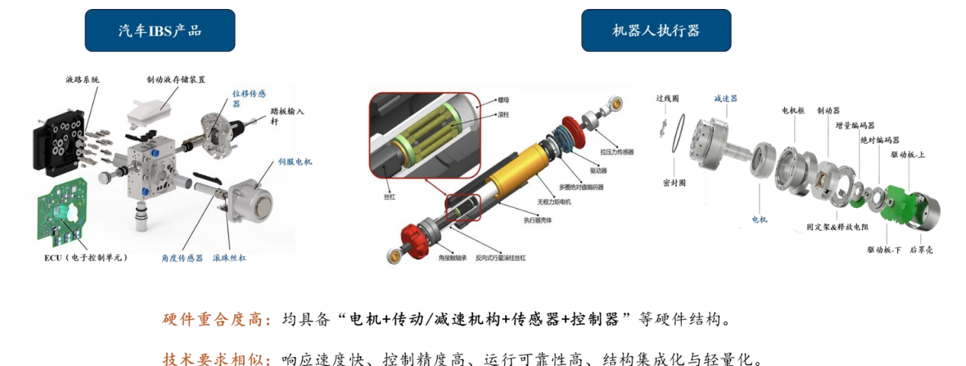
图31：汽车 IBS 产品与人形机器人执行器在硬件构成和技术要求上具有高度一致性
