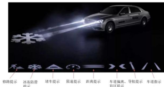
图17: DLP 行车时根据传感器捕捉的信息在路面投影出提示
