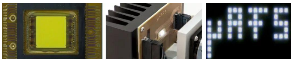
图11: EVIYOS- \mu AFS 式智能大灯示例
