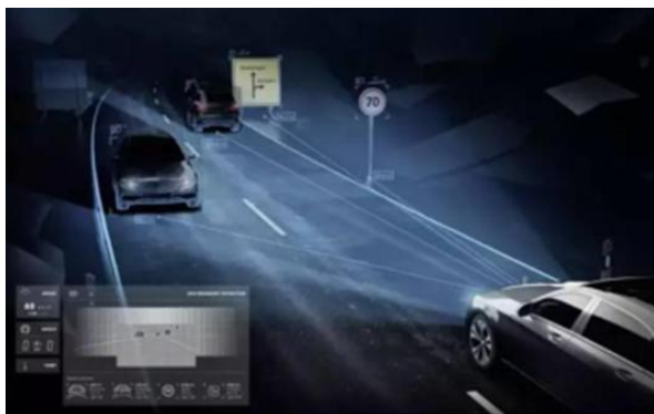
图16: DLP 提供灯光暗区以避免强光影响到前车的驾驶员
