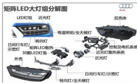
图7: 奥迪矩阵式 LED 大灯组拆解
