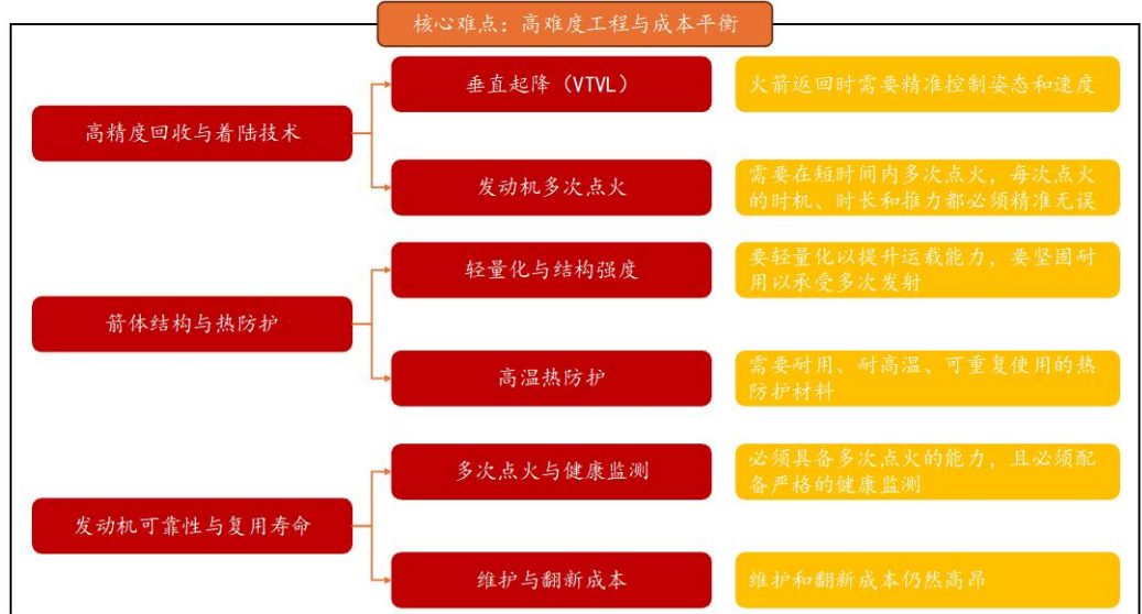
图表 15：可回收火箭技术难度在于高精度回收与着陆技术等方面
