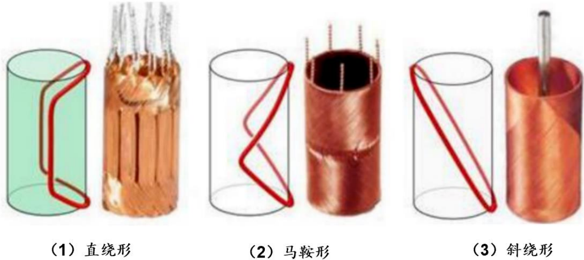
图表12: 线圈绕组方式包含斜绕、叠绕、直绕、马鞍绕和同心绕等
