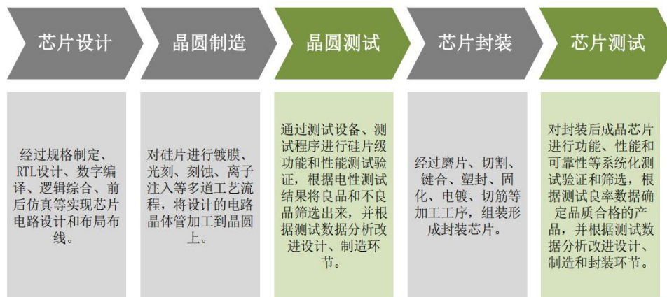
图 1：集成电路封装与测试位于集成电路产业链下游
