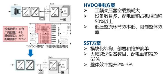
图20: 数据中心 SST 方案与 HVDC 方案对比
