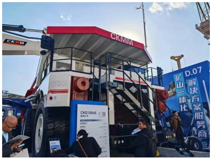
图17: CKG150AE 刚性矿卡, 适用于大型金属矿山、煤矿开采运输
