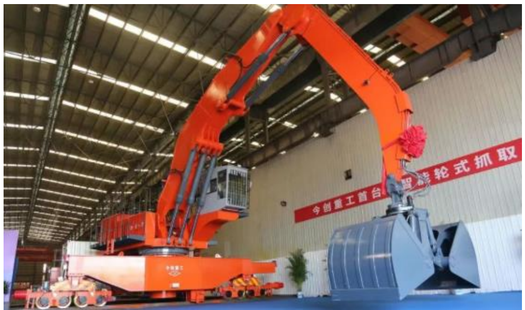
图15：今创集团推出全国首台套港口智能轮式抓取料机 CKJ-2000E
