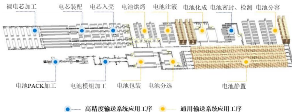
图2：公司智能输送系统在新能源电池生产各环节的应用
