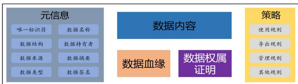
图 3.12 数据胶囊的典型结构
