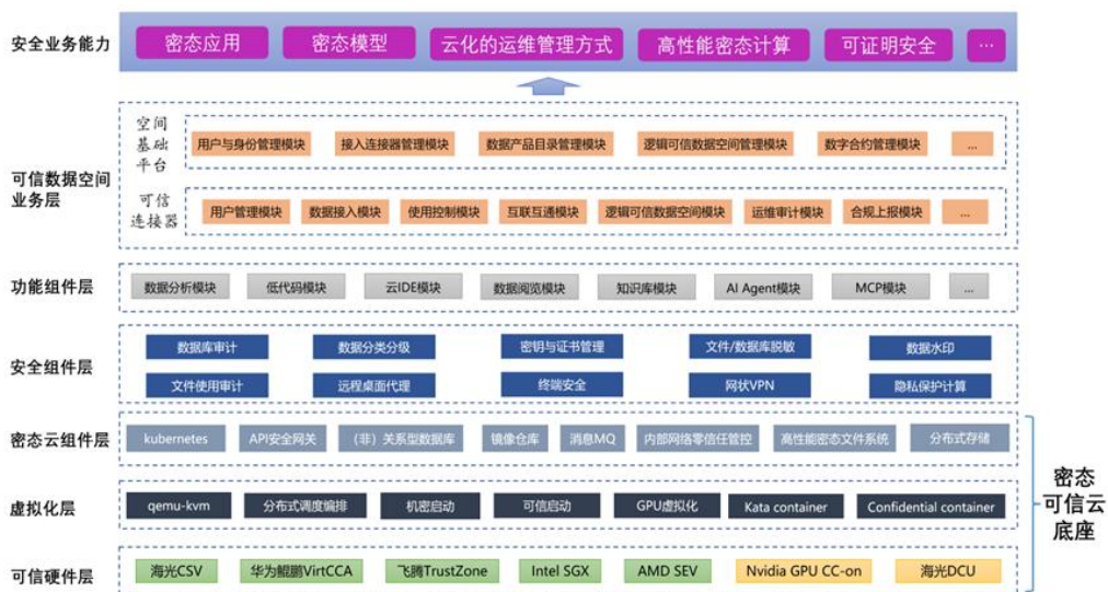
图 3.13 基于密态可信云的可信数据空间系统架构
