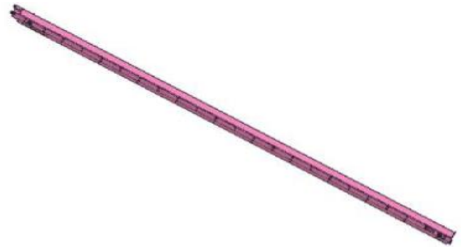
图34：采用 Busbar 为各节点提供电源
