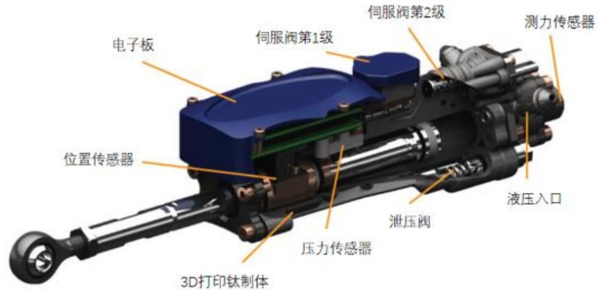
图表42：电液驱动关节结构示意图
