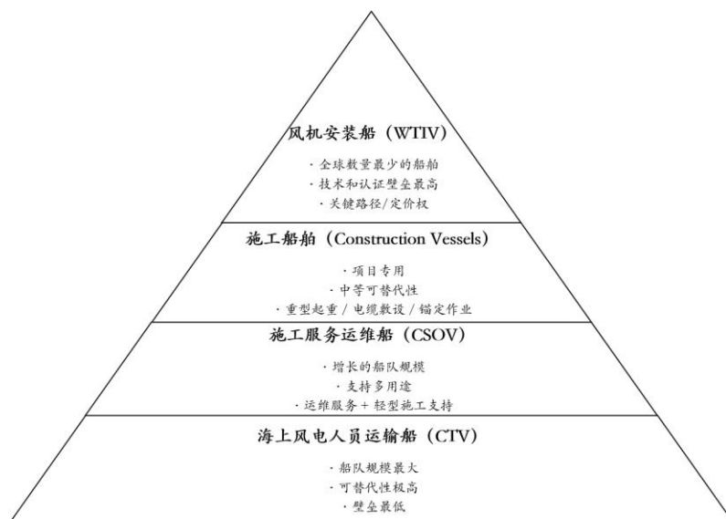
图 22: WTIV / CSOV/CTV / Construction Vessels 结构示意图
