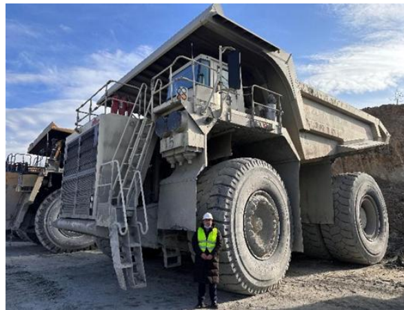
图：北方股份NTE240矿用卡车装配的“陆安” 50/80R57轮胎
