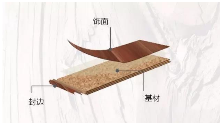
图表69: 板材基材、饰面和封边结构图示
